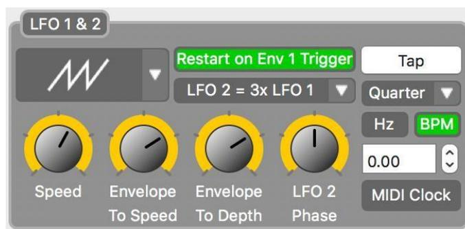
Les LFOs (Oscillateurs à basse fréquence) peuvent être configurés pour contrôler la modulation de filtre.
