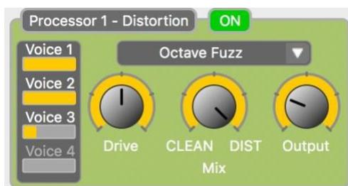
Permet d'ajouter de la distorsion à chacune des voix standard ou d'octave. Le contenu harmonique riche de la distorsion ajoutée accentuera fortement le son des filtres de modulation. La Spectrum inclut 13 types de distorsion, allant de l'overdrive subtil à des effets de fuzz à repliements « Foldback » extrêmes.
