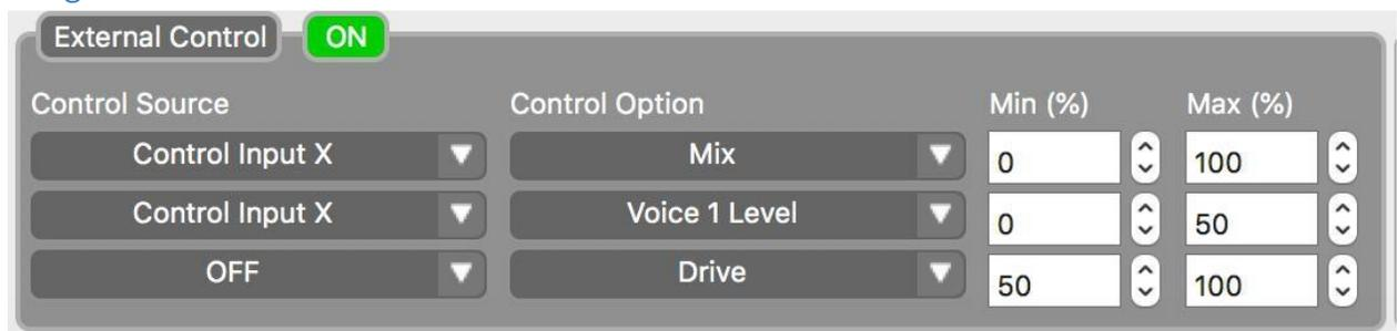
Le bloc « External Control » est utilisé lorsque des réglages d'expression sont assignés à des appareils tels que la Source Audio Dual Expression Pedal, le Hot Hand 3 Wireless Controller, aux autres appareils d'expression sont branchés au Neuro Hub. Tous les appareils d'expression se branchent sur le jack CONTROL INPUT situé sur la partie supérieure de la pédale avec un câble 1/8" TRRS.
