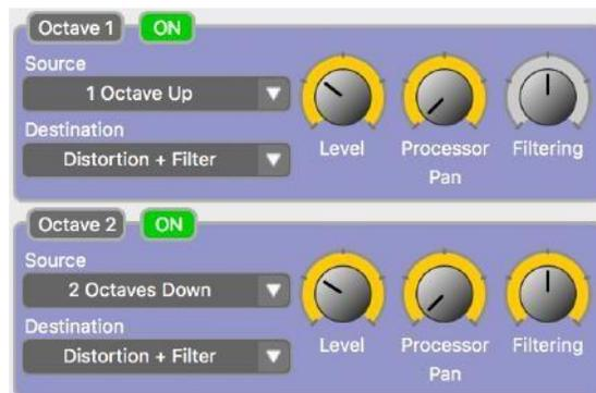
En plus des deux voix standard, la Spectrum dispose de deux voix d'octave monophonique qui peuvent être ajoutées au mix final. Chaque voix d'Octave peut être réglée à l'octave supérieure et jusqu'à deux octaves inférieures.
