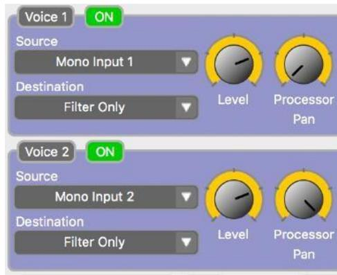
La Spectrum dispose de deux voix (Voice) standard. Chaque voix peut recevoir les signaux provenant de Mono Input 1, Mono Input 2 ou Stereo Input Mix. Les deux modules de voix disposent du même ensemble de réglages.
