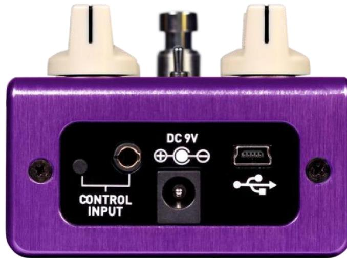
Le port CONTROL INPUT permet d'accéder à plusieurs options de contrôle externes afin de piloter en direct l'un des nombreux paramètres de la Spectrum. Il s'agit d'une entrée pour les pédales Source Audio Tap Switch, Source Audio Dual Expression Pedal, ou un port de données pour le Neuro Hub.
