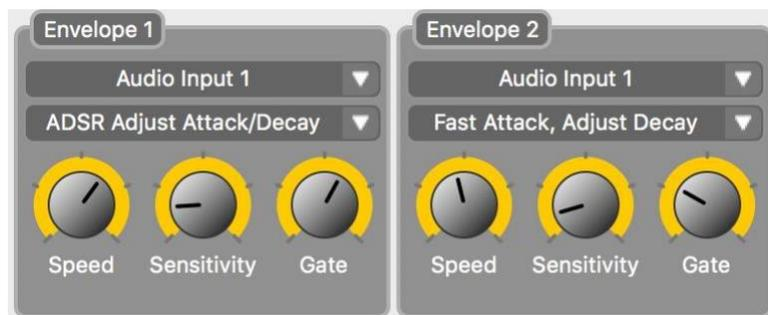
Les réglages Envelope 1 et 2 agissent sur l'amplitude et les filtres de modulation de chaque voix Spectrum. Les deux Envelope 1 et 2 fonctionnent indépendamment l'une de l'autre et peuvent être assignées à un ensemble de voix différentes.
