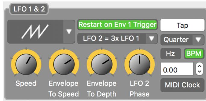
Die LFO (Niederfrequenzoszillatoren) können für die Steuerung der Filtermodulation eingerichtet werden.
