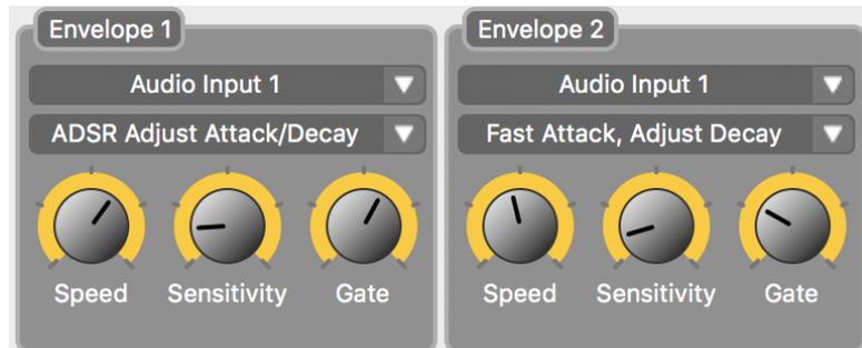
Die Hüllkurven steuern die Amplitude und die Filtermodulation für jede der Stimmen des Spectrum. Beide Hüllkurven 1 und 2 arbeiten unabhängig voneinander und können einem verschiedenen Stimmensatz zugewiesen werden.
