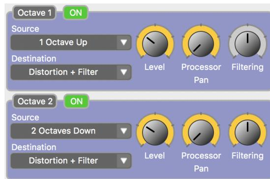
Zusätzlich zu den zwei Standardstimmen verfügt der Spectrum über zwei monophone Octave-Stimmen, die zum abschließenden Mix hinzugefügt werden können. Jede Octave-Stimme kann entweder auf eine Oktave nach oben oder bis zu zwei Oktaven nach unten eingestellt werden.
