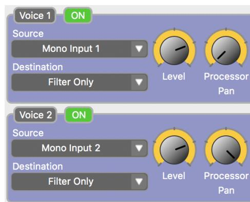
Der Spectrum verfügt über zwei Standard-Stimmen (Voices). Jede Stimme kann ein Signal von Mono Eingang 1, Mono Eingang 2 oder einen Stereo Eingangsmix empfangen. Beide Stimmmodule enthalten den gleichen Satz an Reglern.
