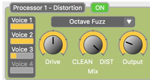
Diese Option fügt jeder beliebigen der Standard- oder Octave- Stimmen Verzerrung hinzu. Der hohe Oberwellengehalt der hinzugefügten Verzerrung wird den Sound des modulierenden Filters stark akzentuieren. Der Spectrum beinhaltet 13 Arten von Verzerrern, alles von einem subtilen Overdrive-Effekt bis hin zu extremen Fuzz-Foldback Effekten.
