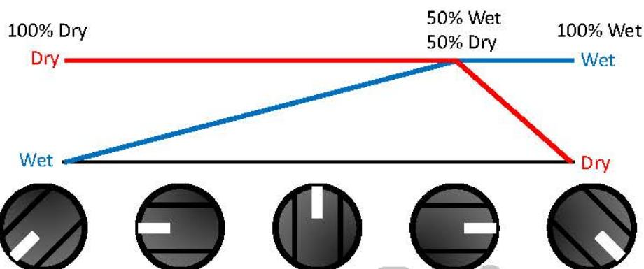
Berte prosím v potaz, že pokud je páčkový přepínač A/B Reverb nastaven v pozici A+B, mění se funkce ovladačů MIX a CONTROL 1 & 2. V režimu A+B ovladač CONTROL 1 nastavuje úroveň reverbu A, ovladač CONTROL 2 nastavuje úroveň reverbu B, ovladač MIX nastavuje úroveň suchého signálu.
