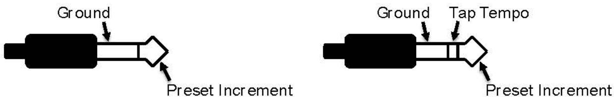
Pomocí editoru Neuro je možné externímu přepínači přiřadit množství různých kontrolních funkcí. Rozšířené možnosti externích přepínačů zahrnují přepínání reverbů z A na B, z A na A+B, tapování tempo, funkci Hold (nebo-li „zamrznutí efektu“), a funkci Build. Úplný popis možností externích přepínačů najdete v sekci [Nastavení nožního přepínače pomocí editoru Neuro](#).
