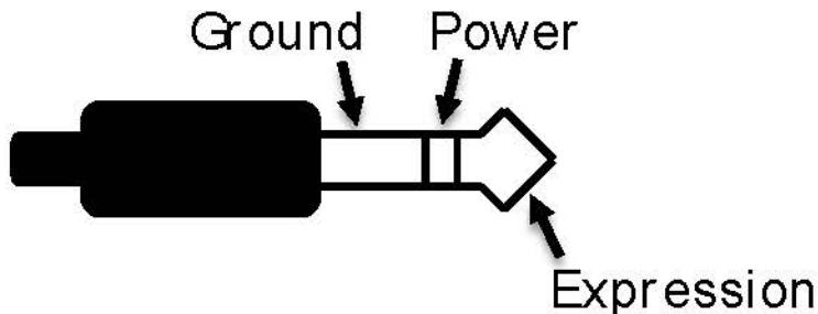
Expression pedály s konektory typu TS (tip-sleeve/špička-objímka) nebudou při zapojení do vstupu PEDAL IN pedálu Ventris pracovat správně. Odpor expression pedálu nehraje v tomto případě roli. Kalibrace pedálu je provedena automaticky, jakmile je vytvořeno nové mapování externího ovladače.
