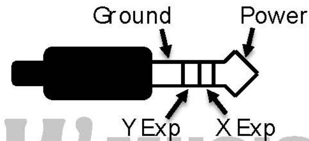
Expression pedály třetích stran je také možné zapojit do konektoru CONTROL IN, a 3,5mm konektoru TRS (tip-ring-sleeve; špička-kroužek-objímka) s kontakty: špička (napětí), mezikroužek (výraz/expression), objímka (uzemnění). Viz následující zobrazení.
