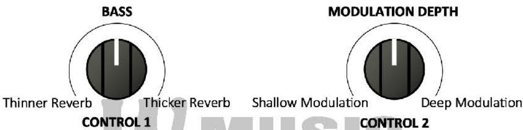
**NOŽNÍ PŘEPÍNAČ OPTION (TAPOVÁNÍ):** *Modulation Rate (rychlosť modulace)* – Pracuje jako tradiční spínač pro tapování tempa pro nastavení rychlosti modulace. To znamená, že sešlapováním přepínače v tempu skladby synchronizujete rychlosť modulace ladění s tempem hrané hudby. Poznámka: abyste změnili rychlosť modulace, musíte přepínač sešlápnout minimálně dvakrát.
